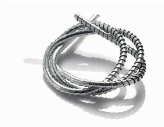
Spanbildung mit herkömmlicher Bearbeitung
